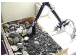
図3: 石灰石鉱山における機械の自動化を考える上で研究を行うための油圧フレカを模した大塊岩石ハンドリング実験装置
