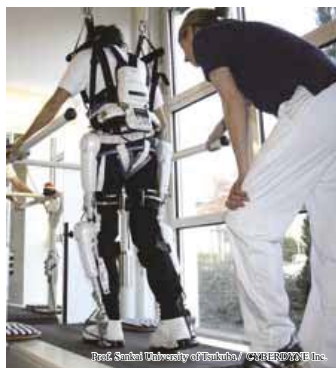
図2: ロボットスーツ HAL 体に装着することによって、人間の身体機能を改善・補助・拡張する世界初のサイボーグ型ロボット
