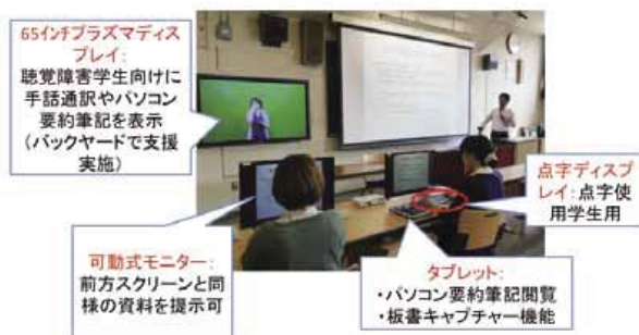
図1：筑波大学内に設置されたバリアフリー講義システムの例
